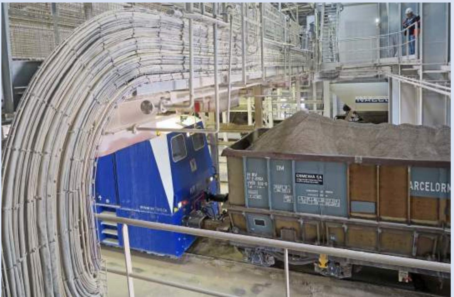
*La locomotive Vollert KR150 n°123 en évolution sur voie 2 à l'intérieur du terminal T2020. Un wagon trémie DM Fal vient d'être chargé en castine en continu, sans dômes successifs. On observe l'arche virtuelle sous laquelle circule le train, comprenant tous les faisceaux de câblage des énergies haute et basse tension, ainsi que les câbles et fibres optiques de télécommunication et de contrôle commande – photographie Patrick Etiévant -*
