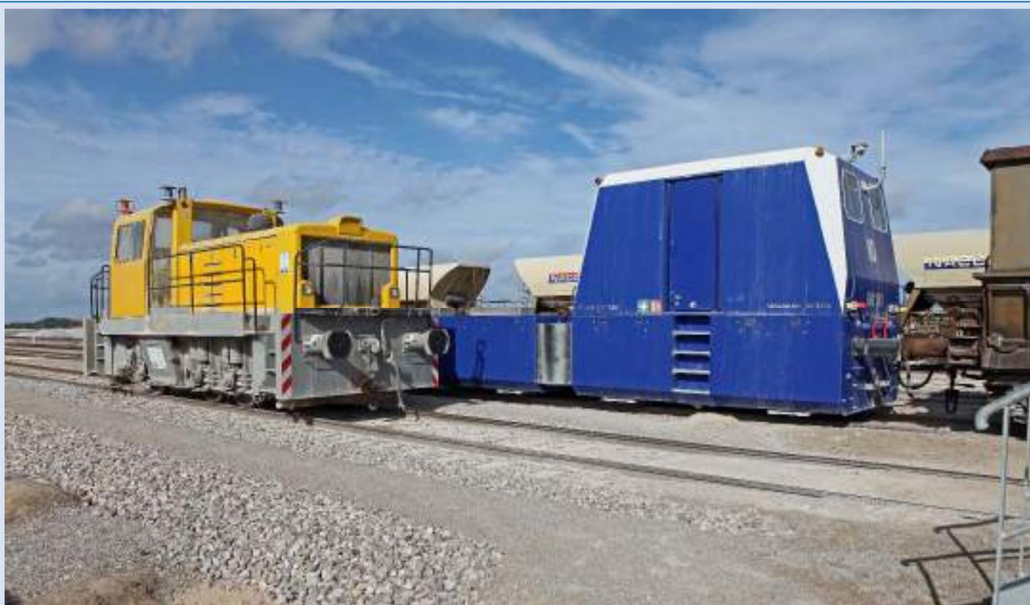
*Un locotracteur diesel électrique Moyse type CN stationne sur voie 1, tandis que la locomotive électrique Vollert KR150 n°123 tractionne à une vitesse millimétrique une rame de wagons trémies DM et DMH en cours de chargement sur la voie 2 du terminal T2020 – photographie Patrick Etiévant -*
