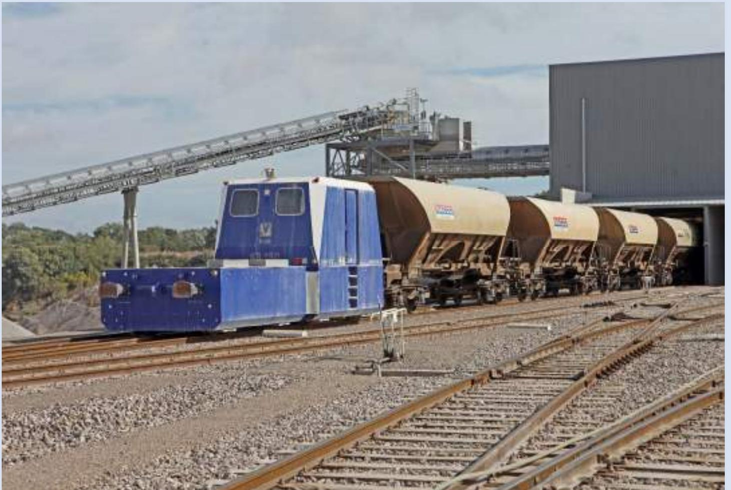
*La locomotive électrique Vollert KR150 n°456 refoule sur la voie 5 du nouveau terminal ferroviaire une rame de wagons trémies EX Nacco qui vient d'être chargée en granulats – photographie Patrick Etiévant -*
